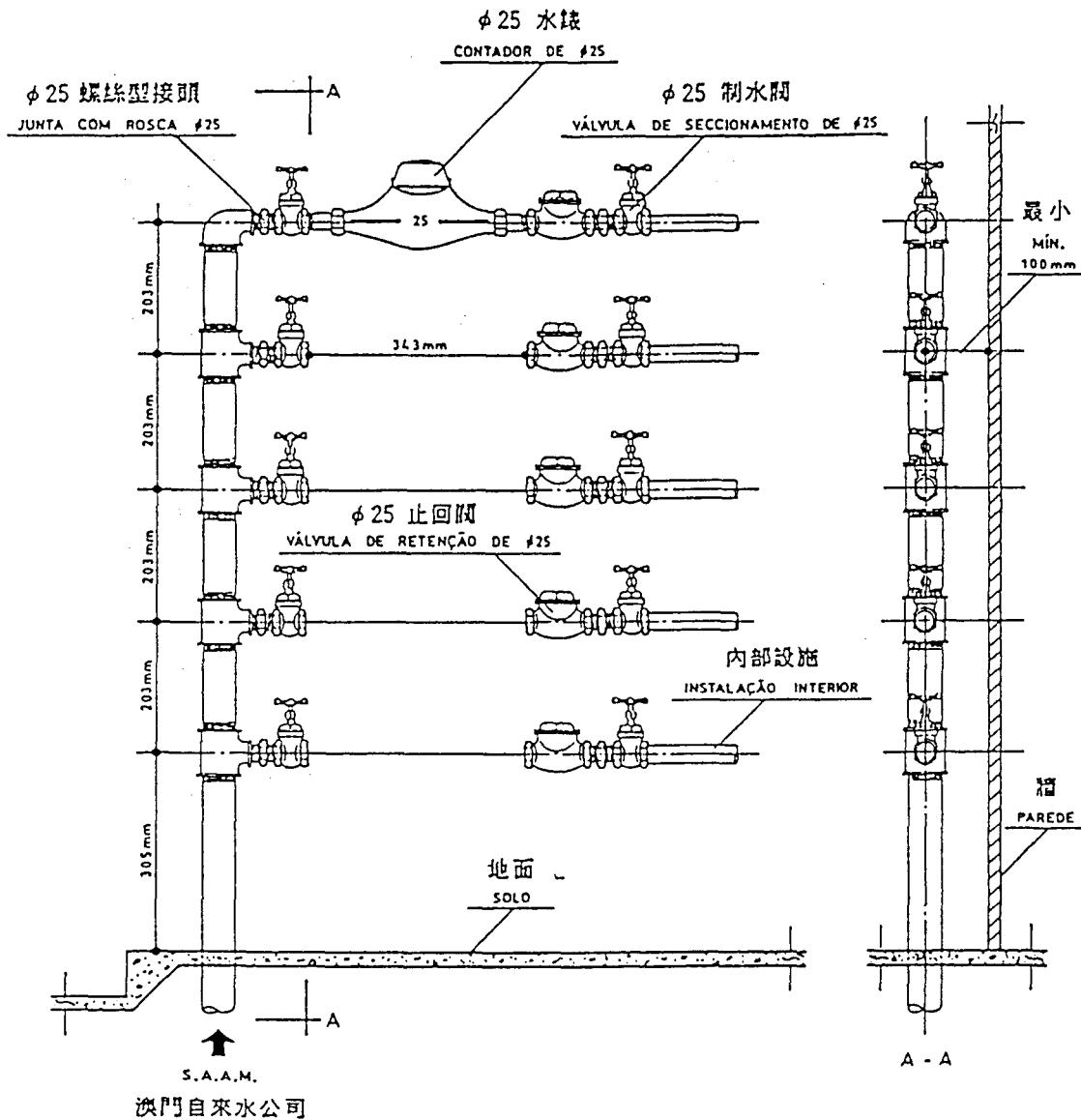
ESQUEMA PARA COLOCAÇÃO DE CONTADOR DE φ25
