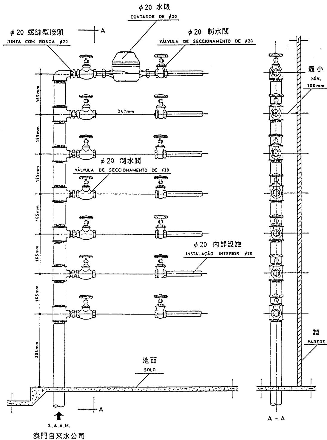
ESQUEMA PARA COLOCAÇÃO DE CONTADOR DE φ20
