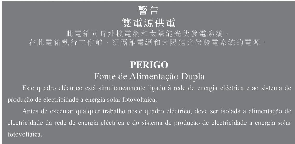
“雙電源供電”警告標誌為一紅色底色的長方形，長150毫米，闊75毫米，其內寫有白色字體的中文字“警告”、“雙電源供電”及葡文字“PERIGO”、“Fonte de Alimentação Dupla”，字體高度為6毫米，其餘的說明均為高4毫米的白色字體。
